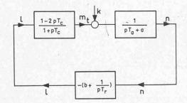
Fig. 4 a. - Diagramme fonctionnel avec l'indication des fonctions de transfert.
