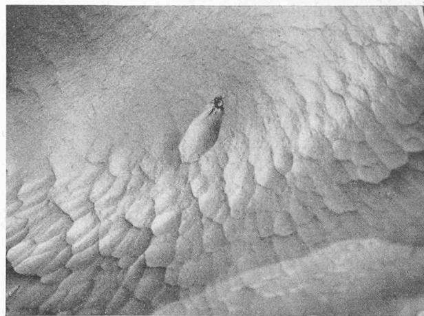
Fig. 11. — Défaut sur la surface de l'une des aubes de la roue en acier au Ni.
