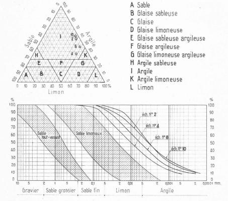
Fig. 4. — Courbes granulométriques de quelques échantillons du sol naturel. Les courbes granulométriques des matériaux des 2 couches du filtre doivent se trouver dans les zones hachurées.
