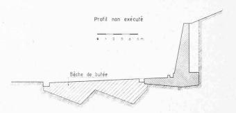
Fig. 8. — Profil d'une bêche de butée simplifiée, non exécutée.
