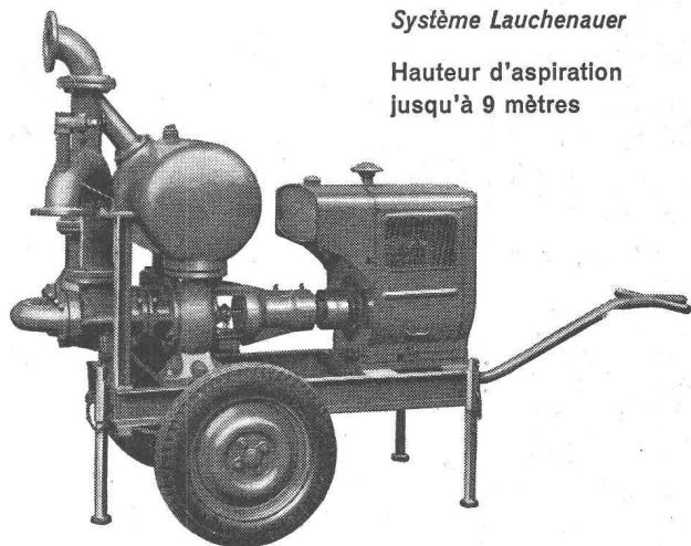
Débits de 1 à 500 litres/seconde. — Pas de soupape de pied, ni de clapet dans la tubulure d'aspiration. — Aucune pompe à vide de secours. — Réamorçage automatique immédiat, même si de l'air est entré dans le tuyau d'aspiration. — Pas de surfaces de contact à frottement et s'usant; par conséquent pas de contretemps même pour l'élévation de la boue, du sable ou du gravier.
