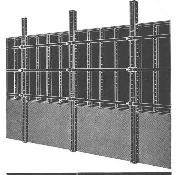
Coffrage plein, grimpant ou glissant pour tous travaux en béton, pour tous genres de coffrage et pour toutes hauteurs de bétonnage
