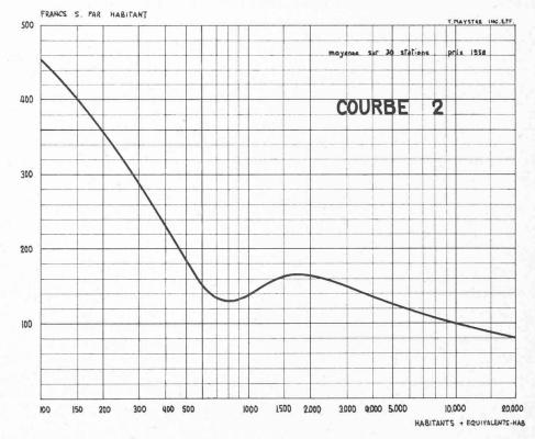
Fig. 2. — Coût par habitant d'une station d'épuration.
