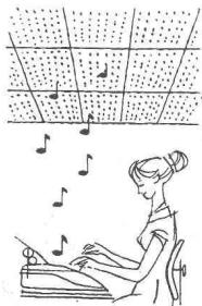
Le chauffage par rayonnement est en même temps un plafond insonorisant, dont le degré d'absorption du bruit peut être adapté aux besoins.
