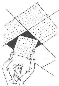
Le plafond ZENT-FRENGER est suspendu au plafond porteur. L'espace intermédiaire est facilement accessible pour l'installation invisible des conduites d'eau, d'électricité, etc.
