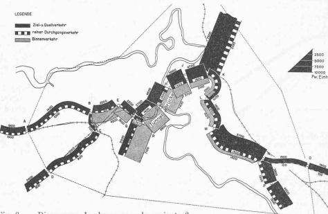
Fig. 8. — Diagramme de charge pour la variante 2.
