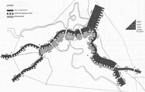
Fig. 7. — Diagramme de charge pour la variante 1.
