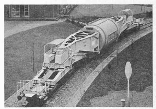
Fig. 4. — Le wagon à 18 essieux et son premier chargement : un générateur BBC de 205 tonnes. La voie étant en courbe, on voit clairement comment s'articulent les différents châssis.
