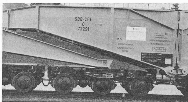
Fig. 3. — Le châssis porteur principal, vu latéralement. (Photo SIG).
