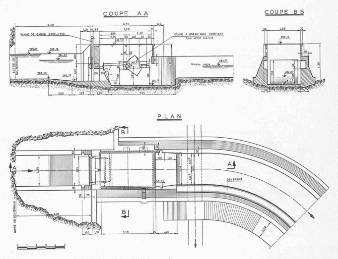
Fig. 8. — Ouvrage de régulation à la sortie d'un tunnel.
