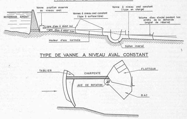
Fig. 2. - Schéma de commande par l'aval.
