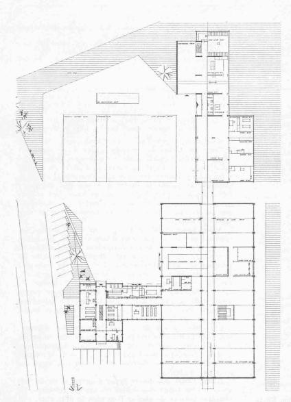
L'implantation générale est bonne, mais les magasins sont trop près de la route cantonale. La zone de verdure, au sud, est trop réduite. Une partie du sous-sol des dépôts représente un volume de construction inutilisé.
