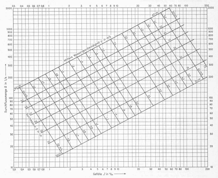
Fig. 4. — Diagramme d'écoulement pour les tuyaux Phlomax Bangerter & Cie S.A., d'après les essais pratiques sur la rugosité.
