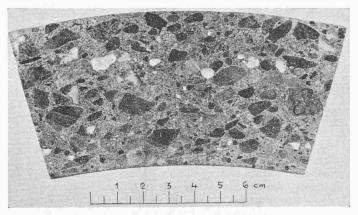
Fig. 1. — Coupe d'une paroi de tuyau.
