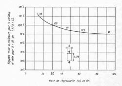
Fig. 2. — Influence de la dimension des éprouvettes sur le chiffre de résistance du béton. Concrete Manual. Bureau of Reclamation.
