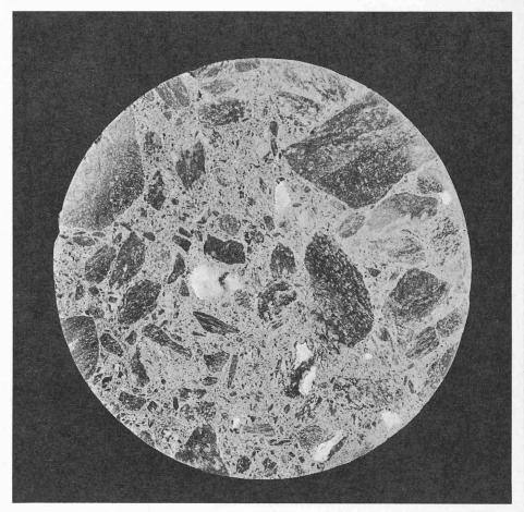
Fig. 15. — Béton de barrage dosé à  $120~\rm kg~CP/m^3$  extrait de la masse par forage. Dosage et malaxage automatiques, transport par bennes de 6 m³, mise en place au bulldozer et vibration mécanisée. Carotte de 30 cm de diamètre.
