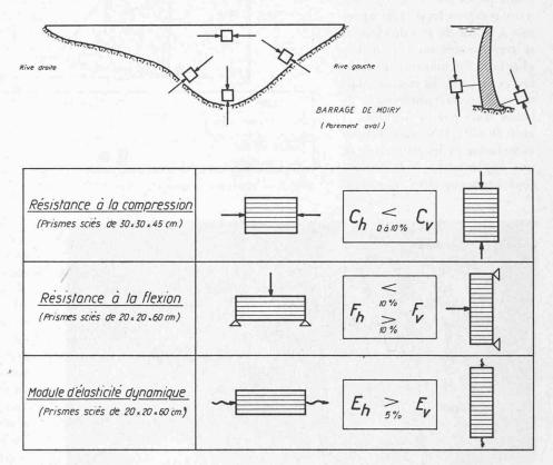
Fig. 7. — Anisotropie du béton.
