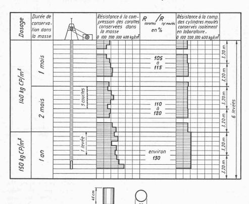
Fig. 9. — Influence de la durée de conservation dans l'ouvrage, sur la résistance à la compression.
