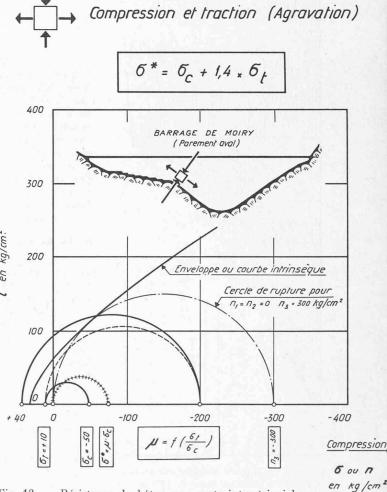
Fig. 13. — Résistance du béton aux contraintes triaxiales. Compression et traction.
