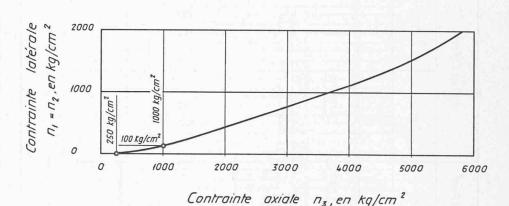
Fig. 11. — Résistance du béton aux contraintes triaxiales.
