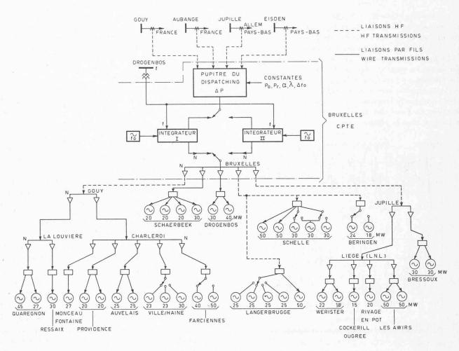
Fig. 4. — Schéma fonctionnel des installations de réglage fréquence-puissance du réseau belge.
