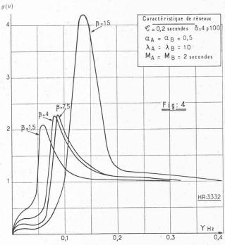
Fig. 4. — Exemple de caractéristiques harmoniques  $\frac{\Delta P_I}{\Delta \Pi_A}$ .
