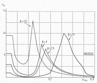
Fig. 5. — Spectre des variations aléatoires de la puissance d'échange.
