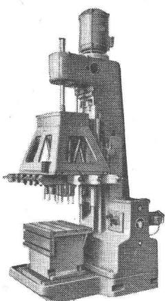
Machines à forer semi-automatiques et à plusieurs arbres porte-forêt avec d'avance hydraulique. Formation d'après vos besoins.
