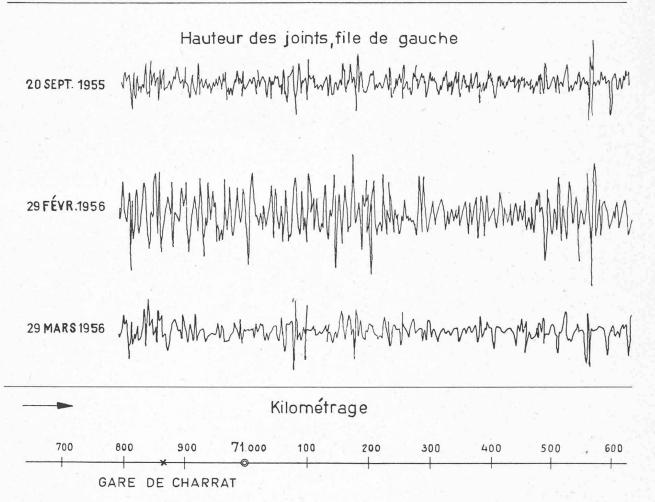
Fig. 3. — Etat des voies sur un tronçon entre Charrat et Saxon, relevé au wagon de mesure CFF, avant, pendant et après la période de gel de février 1956.
