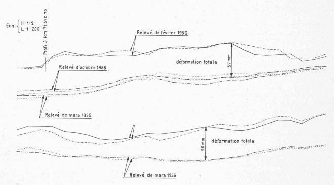
Fig. 2. — Déformations de la voie, mesurées par nivellement des traverses.
