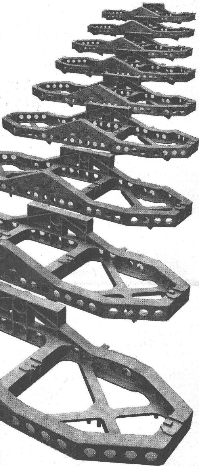
**Supports pour instruments de mesure optiques; longueur environ 2000 mm**
