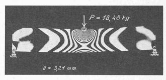
Fig. 5. — Modèle de plaque h/2a=1/6. Photographie des isochromes d'une lame méridienne principale e=3,21 mm, en lumière monochromatique  $\lambda=0,5893~\mu$ .
