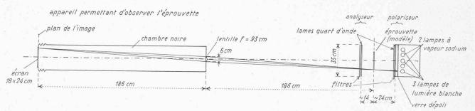
Fig. 7. — Schéma (vue en plan) des appareils, alignés sur le même banc optique, utilisés pour les essais (la lumière se propage de droite à gauche).
