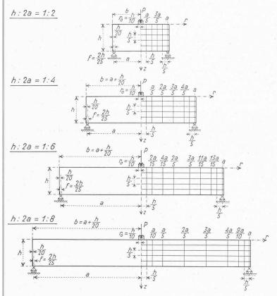
Fig. 9. — Coupe axiale des quatre modèles de plaques étudiés (respectivement vue des modèles des poutres correspondantes), précisant également les points où les tensions ont été déterminées.
