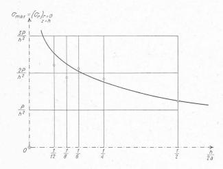
Fig. 21. — Valeurs de la traction dangereuse dans une plaque circulaire  $\sigma_{\max} = (\sigma_r)_{r=0} = (\sigma_t)_{r=0}$  d'après la formule z = h de Woinowsky-Krieger (9) (ligne continue) et d'après les essais (petits cercles), en fonction du rapport h/2a.
