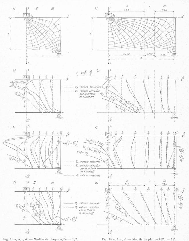
Fig. 13 a, b, c, d. — Modèle de plaque h/2a=1/2. a) Trajectoires des tensions principales b), c), d) Diagrammes des tensions  $\sigma_r$ ,  $\sigma_z$ ,  $\tau_{rz}$  et  $\sigma_t$ .
