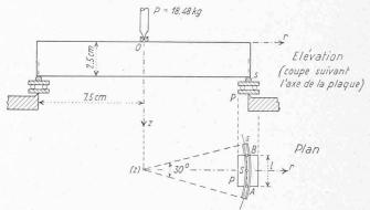
Fig. 10. — Appuis des modèles de plaques circulaires.
