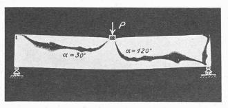
Fig. 3. — Modèle de plaque h/2a=1/6. Photographie des isoclines  $\alpha=30^{\circ}$  (partie gauche) et  $\alpha=120^{\circ}$  (partie droite) d'une lame méridienne principale e=3,21 mm, en lumière blanche.
