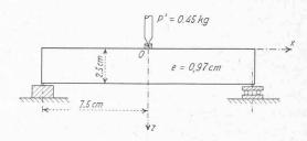
Fig. 11. — Appuis des modèles de poutres simples.
