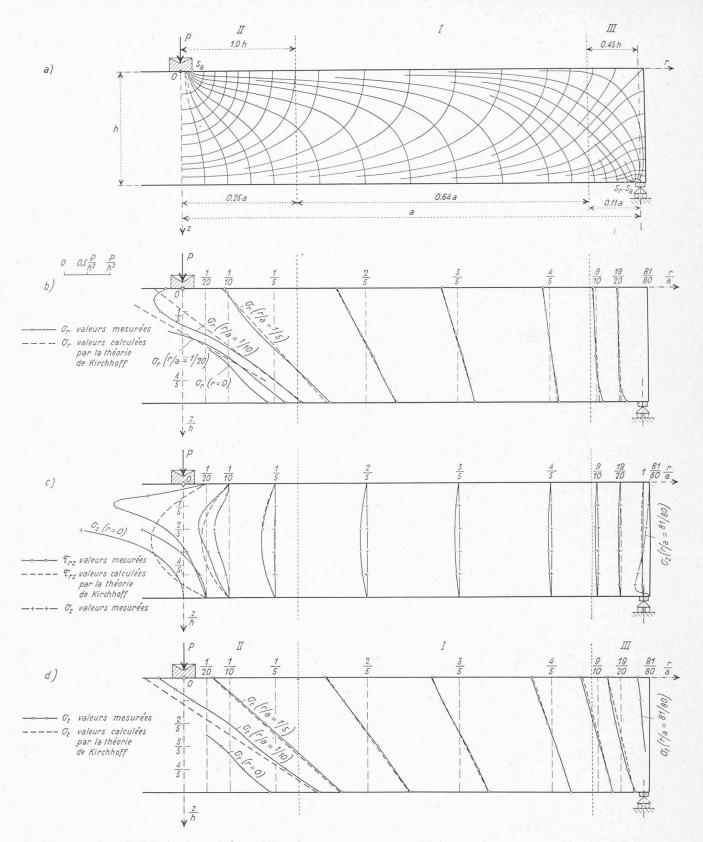
Fig. 17 a, b, c, d. — Modèle de plaque h/2a = 1/8. a) Trajectoires des tensions principales b), c), d) Diagrammes des tensions  $\sigma_r$ ,  $\sigma_z$ ,  $\tau_{rz}$  et  $\sigma_t$ .
