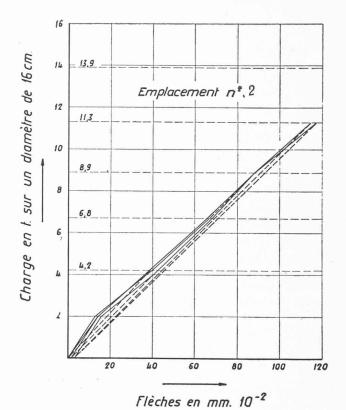
Fig. 16. — Exemple d'un cycle de charge, révélant l'apparition des déformations permanentes.
