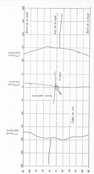
Fig. 27. — Essai à outrance. Dalle non précontrainte. Fissures observées au moment de la rupture.
