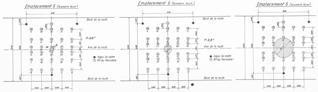
Fig. 20, 21 et 22. — Emplacement 5. Déformations relatives pour les 3 plaques de répartition.
