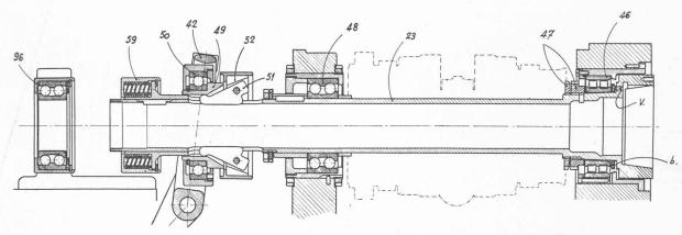
Fig. 3. — Guidage d'une broche de tour automatique monobroche à revolver. Système Tarex, type TAR-H 64 BMM.
