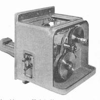
Fig. 14c. — Unité d'entraînement des arbres à cames avec engrenages interchangeables pour cycles de production et dispositif d'accélération permettant d'éliminer les temps improductifs.
