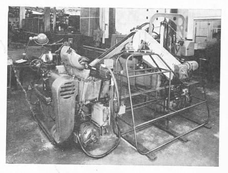
Fig. 13. - Dispositif transfert pour l'usinage automatique d'une pièce d'automobile.
