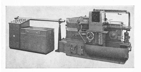
Fig. 7a. — Tour automatique monobroche à revolver type TAR-H pour usinage à vitesse de coupe constante.
