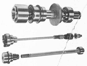
Fig. 14d. — Broche universelle avec dispositifs de serrage interchangeables pour travaux en barre et en mandrin.
