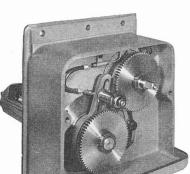
Fig. 14b. — Unité d'entraînement des arbres à cames avec engrenages interchangeables pour cycles de production.
