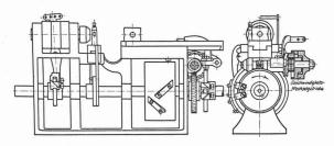
Fig. 1. — Tour automatique monobroche de construction ancienne (système Spencer).
