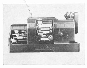
Fig. 9. — Tour automatique à quatre broches Acme-Gridley, pour travaux en barres.
