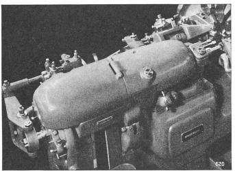
Fig. 9. — Appareil perceur-taraudeur à trois broches employé entre autres dans le décolletage de l'arbre de barillet.
