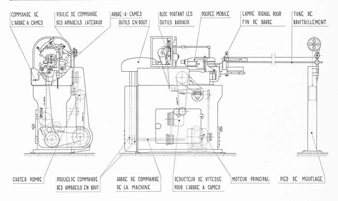
Fig. 2. — Schéma fonctionnel du tour automatique.
