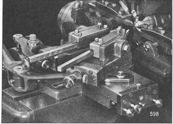
Fig. 10. — Piqueur double 6° et 25° à coulisses pour le décolletage d'axes de balanciers. (Production: 1,8 à 2,8 pièces par minute.)
