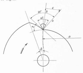
Fig. 12. — Montée sur une came.
