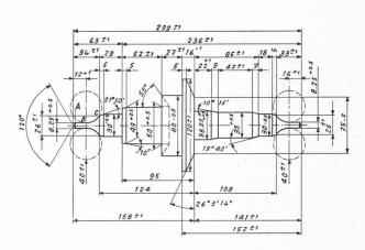
Fig. 4. — Axe de balancier avec cotes et tolérances.
