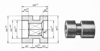
Fig. 14. — Pignon coulant où la pièce est percée, contrepercée et où le carré est étampé avant le tronçonnage.
