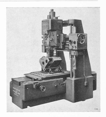
Fig. 10. — Type de machine à pointer dont le moteur et la boîte de vitesse sont situés au-dessus de la broche pour éliminer la chaleur vers le haut de la machine. (Machine Hydroptic-6.)
