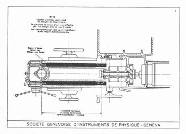
Fig. 12. — Dessin représentant la construction sur barres d'invar de la machine présentée à la figure 11.
