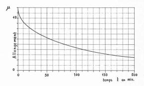
Fig. 3. — Allongement résiduel d'une vis-mère de 1000 mm de long et de 60 mm de diamètre avec filet trapézoïdal après un échaussement initial de 1°C lui conférant un allongement de 11,5 μ.
