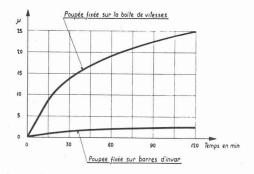
Fig. 13. — Graphique représentant les écarts de position de la broche dont la poupée est fixée directement sur la boîte de vitesse, d'une part, et, d'autre part, dont la poupée est fixée sur des barres d'invar.
