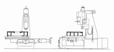
Fig. 7. — Dessin représentant, à gauche, la vue de face d'une machine à pointer monocolonne et particulièrement le chariot porte-table et, à droite, une vue de profil d'une machine à pointer à deux montants.
