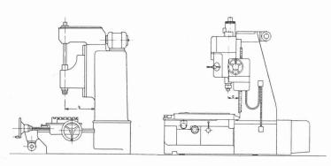
Fig. 8. — Dessin représentant, à gauche, une vue de profil d'une machine à pointer monocolonne et, à droite, une machine à pointer à deux montants.
