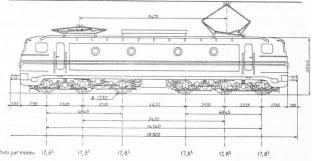
Fig. 2. — Locomotive électrique type CC 7100. Assurant la traction des trains de toute nature sur le parcours (Culoz)-Bellegarde-Genève-Cornavin.
