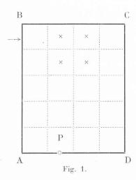
fonctions  $\sigma_x$  et  $\sigma_y$  sont définies au point milieu de chaque petit carré,  $\tau$  est définie aux sommets du réseau. Il est clair que l'on prendra en fait, dans les applications, un réseau plus fin ; mais il est inutile de le faire ici, puisqu'il s'agit simplement d'éprouver la méthode.
