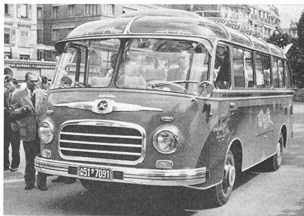
Fig. 18. — Car allemand Setra 6S de la maison Kässbohrer, muni de suspensions Neidhart.
