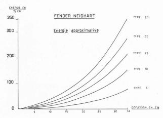
Fig. 12. — Capacité des Fender Neidhart.
