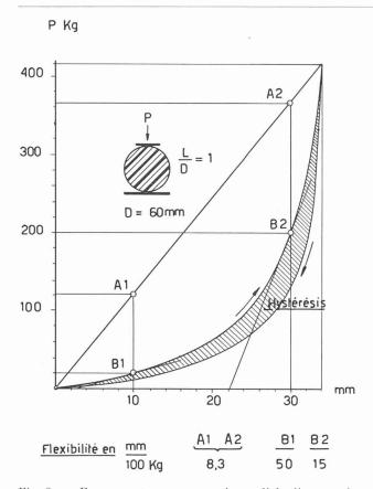
Fig. 3. — Ecrasement par compression radiale d'une corde de caoutchouc de 60 mm de diamètre et 60 mm de longueur. Par comparaison en  $A_1$  et  $A_2$ , la caractéristique rectiligne d'un ressort métallique ordinaire.
