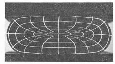
Fig. 9. — Déformation, par compression radiale, d'une corde de caoutchouc.
