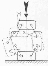
Fig. 11. — Les Fender Neidhart assurent, sur le plan horizontal, une déformation dans toutes les directions.
