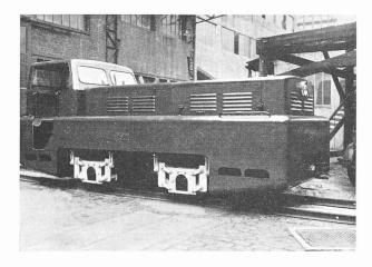
Fig. 15. — Locotracteur pour voie métrique ou normale, construit en série par les Etablissements Campagne, à Paris.
