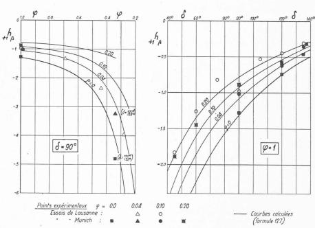
Fig. 20. — Charges  $_{+1}h_{\beta}$  mesurées dans le cas de l'écoulement entièrement dévié,  $q_{\beta}=+$  1.
