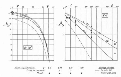
Fig. 21. — Charges  $_{-1}h_{\gamma\beta}$  mesurées dans le cas de l'écoulement provenant entièrement de la branche latérale,  $q_{\beta}=-1$ .
