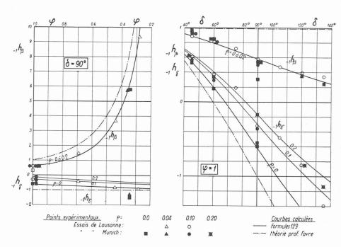
Fig. 22. — Charges  $-1h_{\beta}$  et  $-1h_{\gamma}$  mesurées dans le cas de l'écoulement provenant entièrement de la branche latérale,  $q_{\beta}=-1$ .
