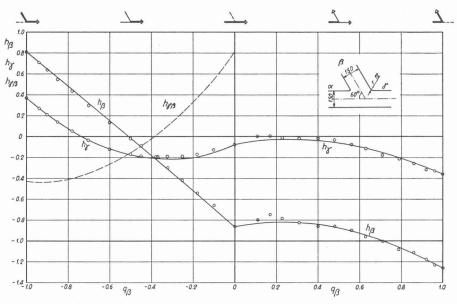
Fig. 12. — Charges mesurées avec la forme 7.  $\phi=1{,}00$ ,  $\delta=60^{o}$ ,  $\rho=0{,}08$
