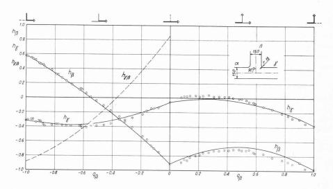
Fig. 6. — Charges mesurées avec la forme 1.  $\phi=1{,}00, \quad \delta=90^{\circ}, \quad \rho=0{,}10$
