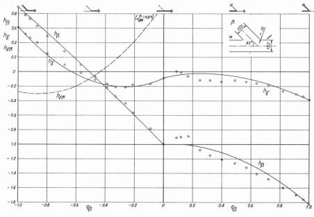
Fig. 11. — Charges mesurées avec la forme 6.  $\phi=1{,}00$ ,  $\delta=45^{o}$ ,  $\rho=0{,}10$
