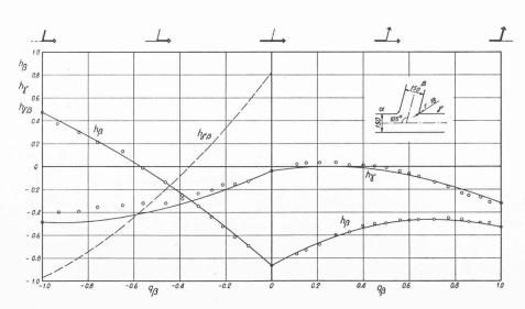
Fig. 14. — Charges mesurées avec la forme 9.  $\phi=1{,}00, \quad \delta=105^{\circ}, \quad \rho=0{,}12$ O Points expérimentaux ——— Courbes calculées
