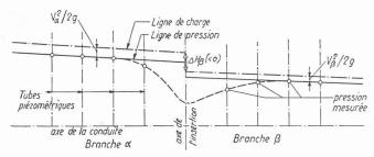
Fig. 4. — Exemple de détermination de différence de charge. (Axe de l'insertion: intersection des axes des branches du Té.)
