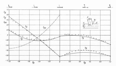
Fig. 13. — Charges mesurées avec la forme 8.  $\phi=1{,}00, \quad \delta=75^{o}, \quad \rho=0{,}12$
