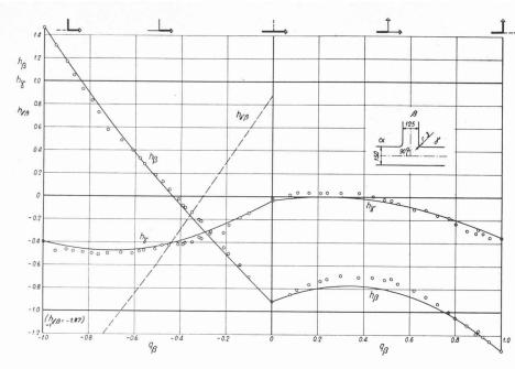
Fig. 7. — Charges mesurées avec la forme 2.  $\phi=0.69, \quad \delta=90^{\circ}, \quad \rho=0.02$
