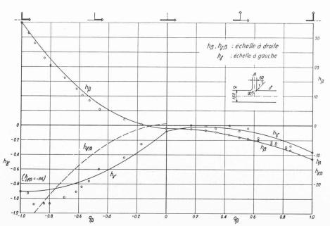
Fig. 10. — Charges mesurées avec la forme 5.  $\phi = 0.16$ ,  $\delta = 90^{\circ}$ ,  $\rho = 0.03$ O Points expérimentaux --- Courbes calculées
