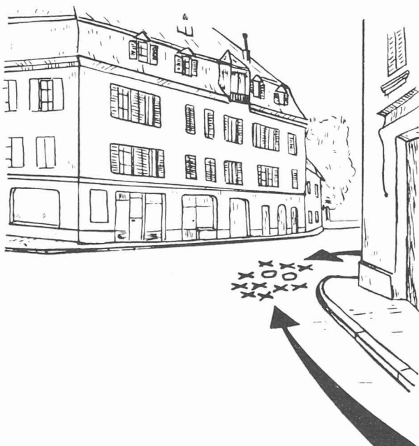
Fig. 10. — Augmentation de la distance de visibilité par simple élargissement d'un trottoir (Vevey).
