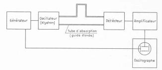
Fig. 9. — Spectrographe à micro-ondes.
