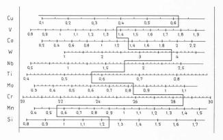
Fig. 2. — Exemple de l'analyse d'un acier sur l'enregistreur du quantomètre.
