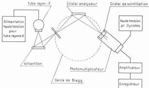
Fig. 3. — Schéma d'un spectromètre à rayons X.
