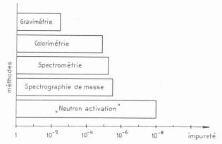
Fig. 5. — Sensibilité des différentes méthodes pour la détection des impuretés.
