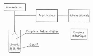
Fig. 6. — Poste de mesure pour isotopes radioactifs.
