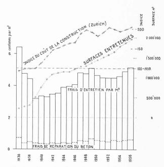
Fig. 1. — Entretien des revêtements de béton en Suisse.
