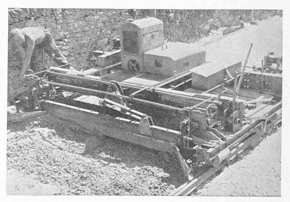
Fig. 4. — Petite machine régleuse-finisseuse à faible encombrement.
