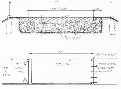
Fig. 3. — Route agricole en béton: coupe et situation.
