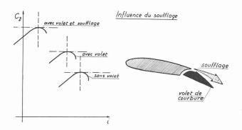
Fig. 8. — Effet du soufflage d'air sur l'aile. Ici, le soufflage est pratiqué à la hauteur du volet de courbure. Courbes comparatives  $c_z$  en fonction de i.
