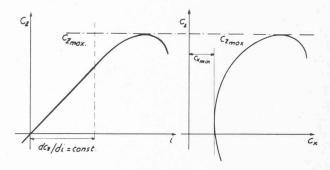
Fig. 4. — Représentations schématiques des coefficients de portance  $(c_z)$ , de traînée  $(c_x)$  et de l'incidence i.
