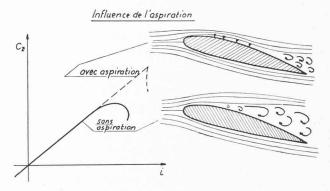
Fig. 7. — Effet de l'aspiration de la couche-limite.
