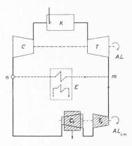
Fig. 6. — Schéma d'installation simple de turbine à gaz.
