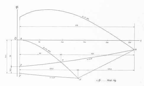
établie sur la base d'un diagramme i —  $\Phi$  tracé pour 1 kg d'air dont la chaleur spécifique sous pression constante varie linéairement avec la température.
