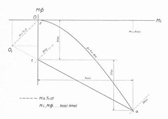
Fig. 3. — Refroidissement isobare d'un gaz dont la chaleur spécifique est  $M.c_p=5~{\rm kcal/kmol.^o}\,\Delta T~({\rm gaz\text{-}type})$  et détermination du travail continu maximum que l'on pourrait obtenir entre les mêmes conditions thermiques extrêmes.
