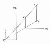
Fig. 5. — Représentation sommaire en diagramme  $M.i-M.\Phi$  d'un cycle de Carnot parcouru par un gaz parfait  $(M.c_p=5 \text{ kcal/kmol.}^{\circ}\Delta T)$   $1\rightarrow 2=\text{compression}$  isothermique à la température de la source froide;  $2\rightarrow 3=\text{compression}$  isentropique;  $3\rightarrow 4=\text{détente}$  isothermique à la température de la source chaude;  $4\rightarrow 1=\text{détente}$  isentropique.
