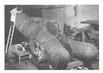
Fig. 29. — Conduite forcée de Canastra, au Brésil. Essai en atelier d'une des culottes inférieures. Mesures extensométriques par jauges à fil résistant <sup>16</sup>.
