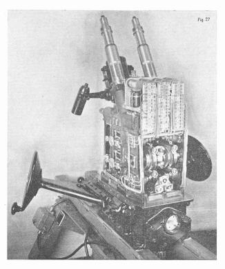
Fig. 27. — Servo-viseur sans tête de visée et capot.
