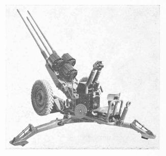
Fig. 28. — Affût HSS-635 avec servo-viseur.
