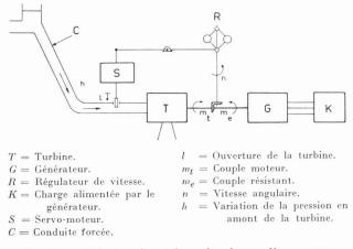
Fig. 1. — Principe du réglage de vitesse d'un groupe hydro-électrique.
