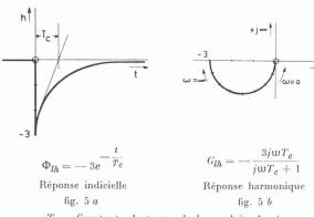
$T_{\rm c}=$  Constante de temps de la conduite forcée.
