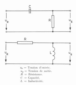
Fig. 18. — Régulateur différentiel purement électrique.
