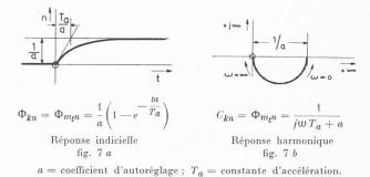
Fig. 7. — Réponse de la vitesse «n» du groupe à une variation du couple moteur « $m_t$ » ou de la charge k.
