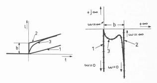
fig. 12 a Réponse indicielle fig. 12 b Réponse harmonique
