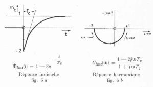
Fig. 6. — Réponse du couple moteur « $m_t$ » à une variation de l'ouverture «l» de la turbine.
