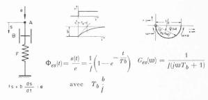
Modèle Réponse indicielle  $\Phi_{es}(t)$  Réponse harmonique  $G_{se}(w)$  fig. 4 a fig. 4 b fig. 4 c
