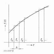
Fig. 2. — Décomposition d'une fonction en une suite d'impulsions.
