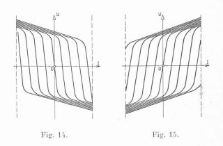
Fig. 14. — Caractéristiques d'une génératrice à courant continu avec asservissement négatif en fonction de la tension.
