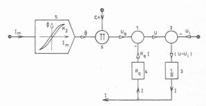
Fig. 6. — Schéma fonctionnel correspondant à la figure 5.
