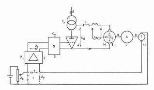
Fig. 28 a. — Schéma du réglage de vitesse d'un moteur à courant continu au moyen d'un redresseur à vapeur de mercure.
