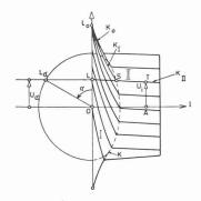
Fig. 31. — Caractéristique externe du redresseur biphasé.
