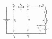
Fig. 1. — Schéma électrique d'une source de tension  $U_q$  avec une résistance interne  $R_q$  et un circuit de charge constitué de  $U_i$ , R et L.
