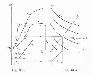
Fig. 33 a. — Caractéristique de réglage d'un amplificateur magnétique.
