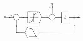
Fig. 19. — Schéma fonctionnel d'une génératrice à courant continu avec asservissement en fonction du courant.
