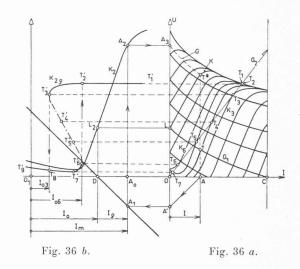
Fig. 36 b. — Caractéristique de réglage d'un amplificateur magnétique avec coefficient d'asservissement très élevé.
