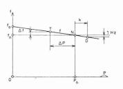
Fig. 25 b. — Caractéristique puissance/fréquence d'un groupe turbine/générateur.
