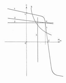
Fig. 23. — Caractéristiques couple-vitesse d'un moteur.
