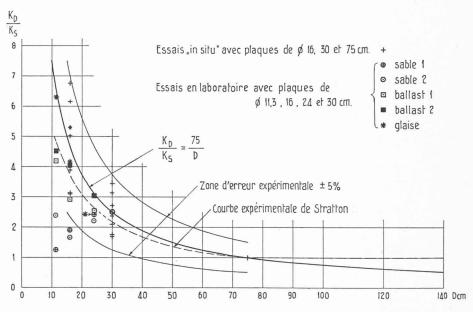
Fig. 5. — Ecarts entre les résultats d'essais exécutés avec des plaques de différents diamètres et la courbe théorique
