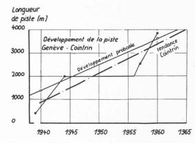
Fig. 4. — Développement de la piste de Cointrin. Tendance résultant des valeurs adoptées pour Cointrin. Développement probable des longueurs de piste, tel qu'il ressort des statistiques sur la charge alaire.
