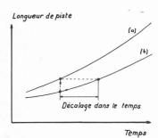
Fig. 3. — Représentation schématique et qualitative des courses au décollage et à l'atterrissage dans leur développement historique.
