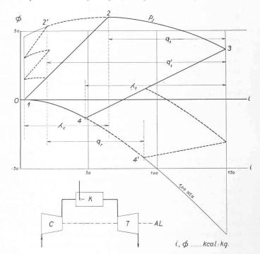
Schéma simplifié et diagramme de fonctionnement idéal de turbines à gaz en circuit ouvert.
