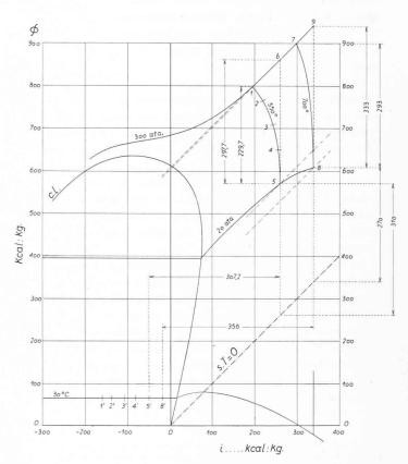
Fig. 5. — Diagramme enthalpie-potentiel thermodynamique relatif à la vapeur d'eau avec indications concernant les lectures de différences de *i* et de ø correspondantes aux principales transformations à envisager.
