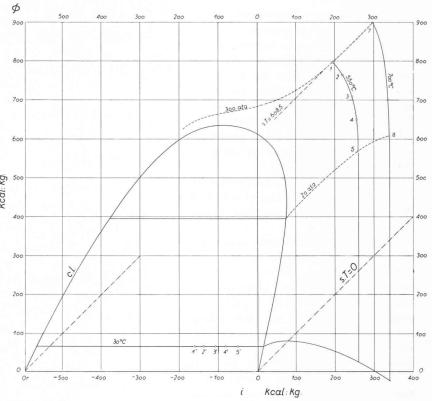
Fig. 4. — Diagramme enthalpie-potentiel thermodynamique relatif à la vapeur d'eau (domaine de la saturation et de la surchauffe) avec indication de quelques courbes caractéristiques (courbe-limite, isobares, isothermes, s.T=ct).
