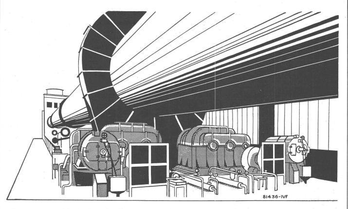
Deux moteurs triphasés shunt à collecteur de 220 ch entraînent à vitesse réglable de façon continue un des plus grands fours rotatifs du monde
