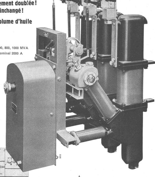
A Disjoncteur à faible volume d'huile type VS 10. 12, 10 kV, 1200 A, 500 MVA, avec commande à moteur et déclencheurs à courant principal.
