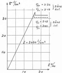
Fig. 12. — Essai de traction. Matière après traitement thermique.
