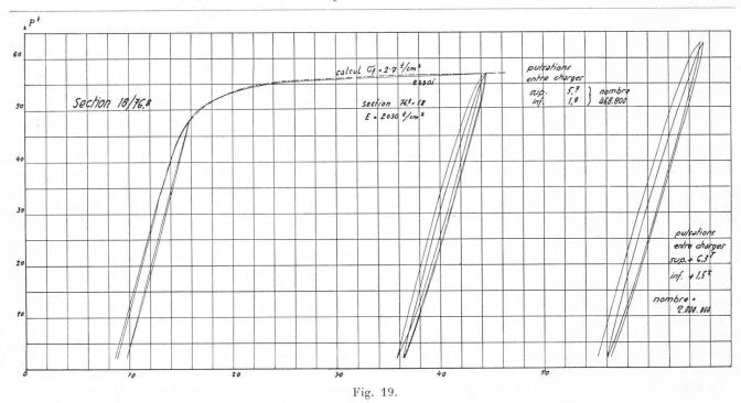
l'éprouvette a subi 1 000 000 pulsations sans qu'aucune rupture ne survienne.
