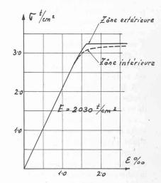
Fig. 13. — Essai de compression. Matière après traitement thermique.
