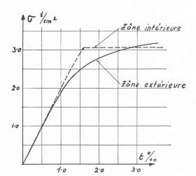
Fig. 11. — Essai de traction. Matière en état de livraison.
