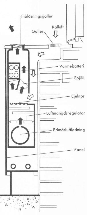
Fig. 10. — Coupe schématique d'un appareil « Velovent ».
