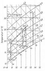
Fig. 13. — Diagramme i-x avec abaque pour une installation de climat-convecteurs.
