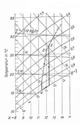
Fig. 12. — Diagramme i-x avec abaque pour une installation conventionnelle.
