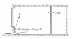
Fig. 2. — Appareil individuel de climatisation pour un bureau.
