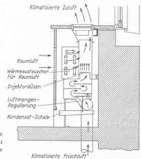
Fig. 4. — Principe de fonctionnement du climat-convecteur de Carrier.
