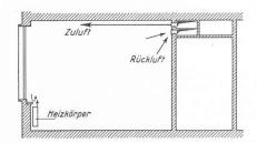
Fig. 1. — Ventilation d'un bureau à l'aide de gaines (système conventionnel).
