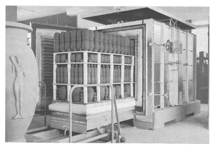
Four électrique Brown Boveri à chariot d'une capacité utile de 2,4 m³ pour une température maxima de 1300 °C (montre de Seger n° 10)
