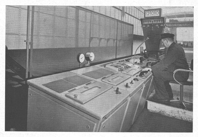
Pupitre de commande d'un laminoir équipé de compensateurs automatiques indiquant les températures et les pressions.
